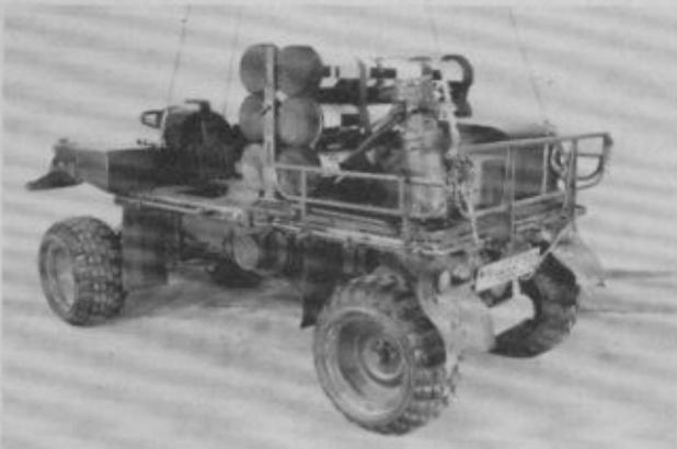
Abb 10: LKW 0,75 t gl mit Einbausatz PzAbwWaSys MILAN fertig zum Lufttransport
